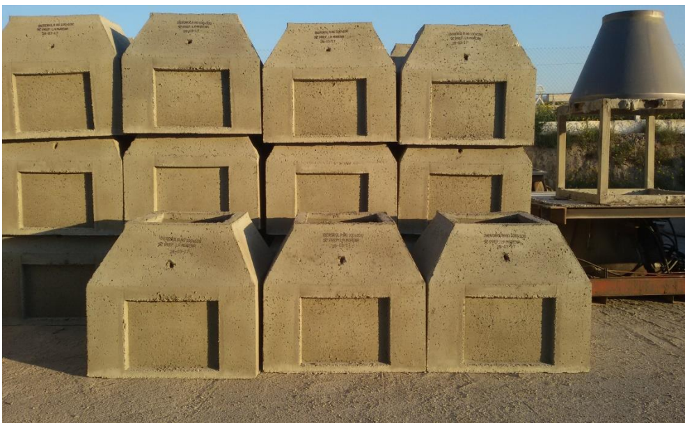
ARQUETA AG 100*100 IBERDROLA
